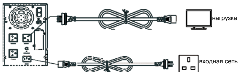
п. 3.2.2 Tower 500VA - 2KVA вход/выход схема подключения
